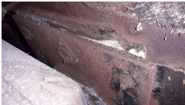
Prélèvement - P57 : R-1 / OS1.03 - Joint- (Absence d'amiante)
