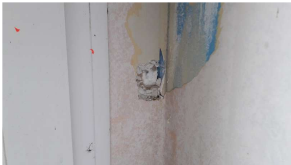
Prélèvement - P32 : R+0 / 00.020 - Bande de plaque de plâtre- (Absence d'amiante)
