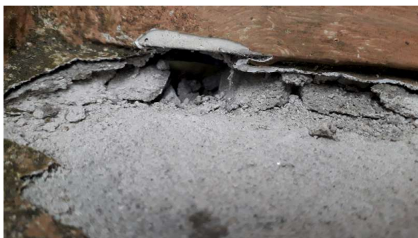
Déclaré - : R+2 / 02.001 - Joint- (Absence d'amiante)
