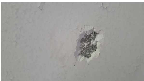
Prélèvement - P14 : R+1 / 01.009 - Peinture- (Absence d'amiante)
