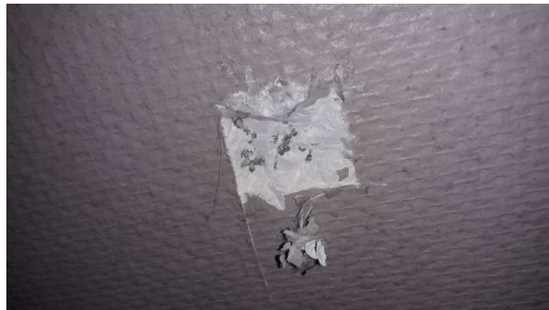
Prélèvement - P74 : R+0 / 00.008 - Peinture- (Absence d'amiante)
