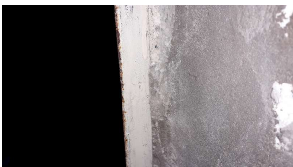
Prélèvement - P9 : R+2 / 02.004 - Rebouchage- (Absence d'amiante)
