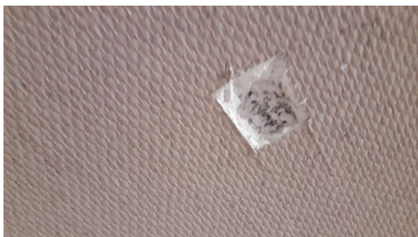
Prélèvement - P39 : R+0 / 00.021 - Peinture- (Présence d'amiante)
