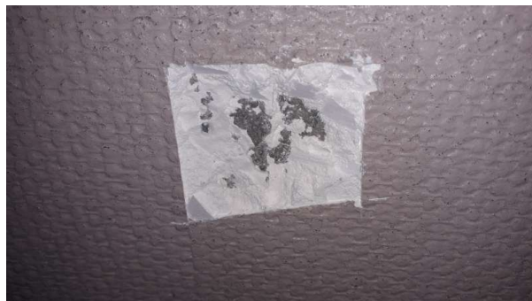
Prélèvement - P78 : R+1 / 01.002 - Peinture- (Absence d'amiante)
