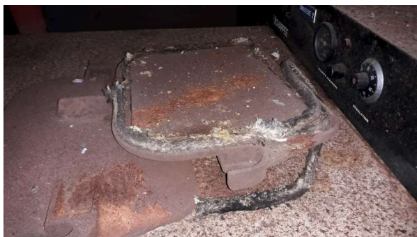
Prélèvement - P59 : R-1 / OS1.03 - Joint- (Absence d'amiante)
