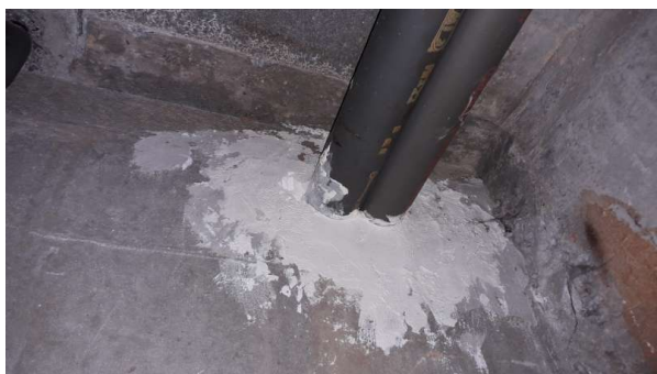
Prélèvement - P43 : R-1 / 0S1.16 - Rebouchage- (Absence d'amiante)
