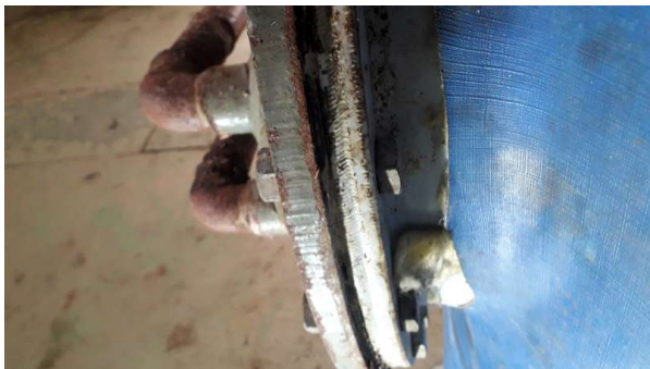
Prélèvement - P54 : R-1 / 0S1.03 - Joint- (Présence d'amiante)
