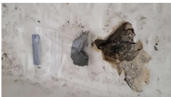
Prélèvement - P25 : R+1 / 01.010 - Revêtement bitumineux- (Absence d'amiante)
