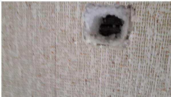
Prélèvement - P13 : R+1 / 01.009 - Revêtement- (Absence d'amiante)
