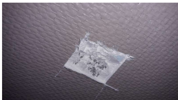
Prélèvement - P79 : R+1 / 01.019 - Peinture- (Absence d'amiante)
