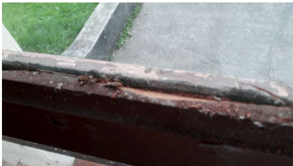
Prélèvement - P65 : R+0 / 00.019 - Mastic- (Absence d'amiante)
