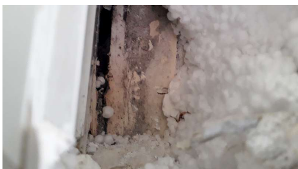
Prélèvement - P34 : R+0 / 00.020 - Joint d'étanchéité entre menuiserie et structure- (Absence d'amiante)
